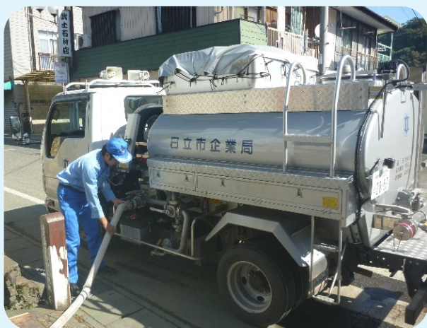
消火栓から給水車への充水の様子(大子町にて)
